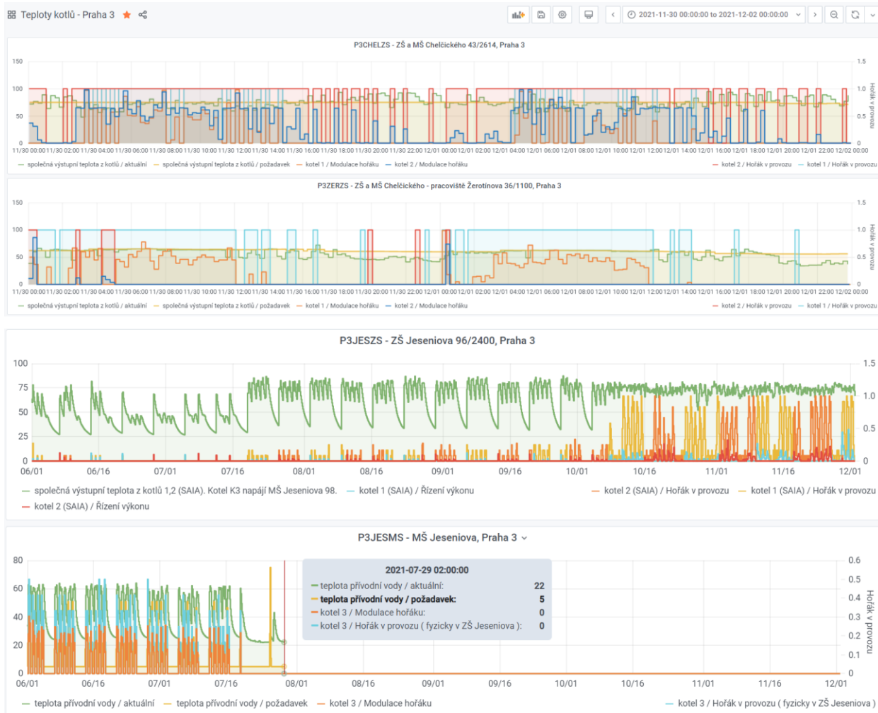
Obrázek č. 8 - Dlouhodobá analýza provozních parametrů plynových kotlů
